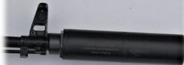
Le RDS VORTEX 8 AK-74 est le modèle VORTEX destiné au fusil AK-74 / AKSU et ses dérivés civils filetés en M24x1,50 RH. Il se monte donc sans modification à la place du cache-flammes d'origine.
